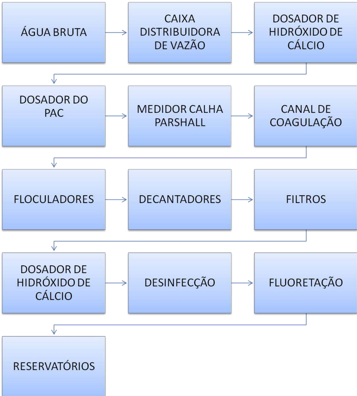
Figura 12 - Etapas do tratamento convencional da água.
