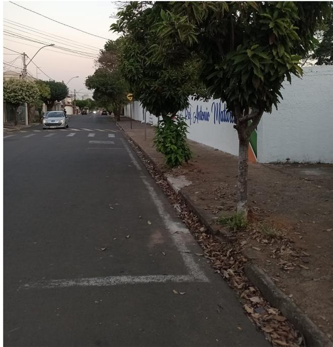
Conforme foto acima, às árvores ali plantadas impedem que as vans escolares possam realizar manobra correta para estacionar bem rente ao meio fio, atrapalhando a passagem de veículos. Desta forma, sugerimos que a demarcação para embarque e desembarque das vans seja alterado e demarcado após a lombada, onde não há árvores plantadas, assim, resolvendo ou amenizando o problema ora enfrentado pelos condutores.
